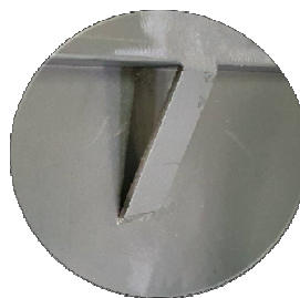
Anses de levage sur la largeur
